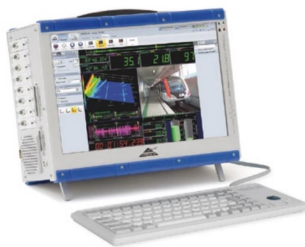
Hình 3. Máy đo dao động đa kênh DEWE-3020 sử dụng trong thí nghiệm.
