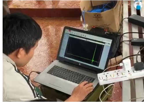
a. Sơ đồ bố trí thí nghiệm; b. Công tác lắp đặt, bố trí đầu đo và lượng nổ; c. Tiến hành nổ; d. Kiểm tra dữ liệu tín hiệu số trên máy tính; (L- khoảng cách từ đầu đo gần nhất tới lượng nổ).
